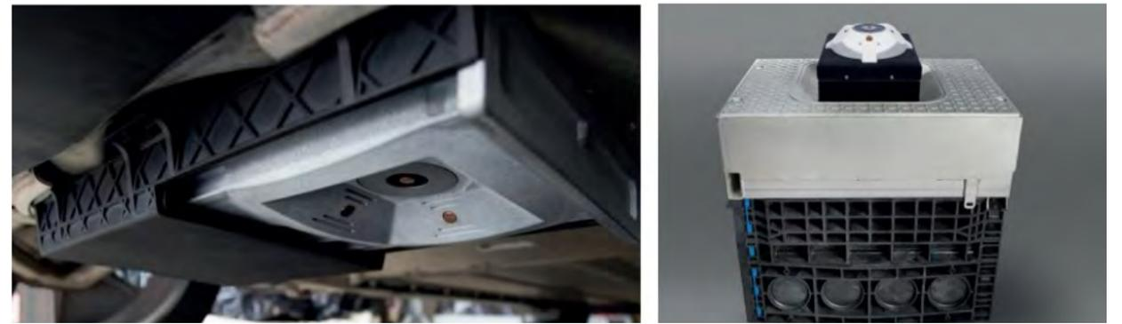
차량 인식 자동화 기술이 결합하면 언더바디 충전 시스템은 추가적인 조작 없이 편리하게 충전이 가능해진다.
